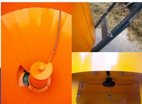
Ein elektrisch angetriebenes Rührwerk und Fördererband verteilen die Einstreu in die Liegeboxen. Die Schnecke in dem Behälter wirkt gegen Brückenbildung und mischt eventuell den Kalk mit dem Sägemehl vor der Ausbringung. Das Förderband kann nach links oder rechts auswerfen. Die Wurfweite ist durch die Geschwindigkeit des Bandes einstellbar.
